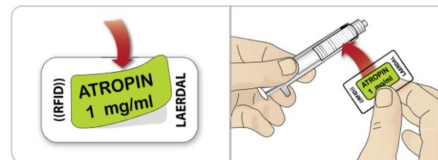
注: タグを注射器に貼る際は、できるだけ針先に近い位置に貼るようにしてください。
