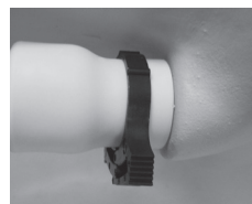
照片 7 安装夹具并压紧。
