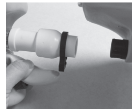
Bild 5 Skjut slangen tills den möter den upphöjda kanten på anslutningen.
