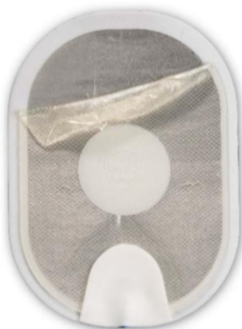
Figure 1 : gel décollé qui s'est replié sur lui-même lors du retrait de la feuille de protection.
