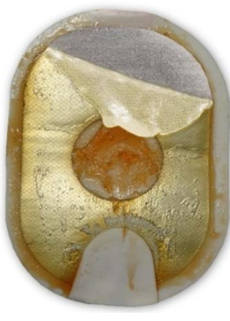
Figure 2 : le gel décollé et replié peut également sembler décoloré et/ou fondu.
