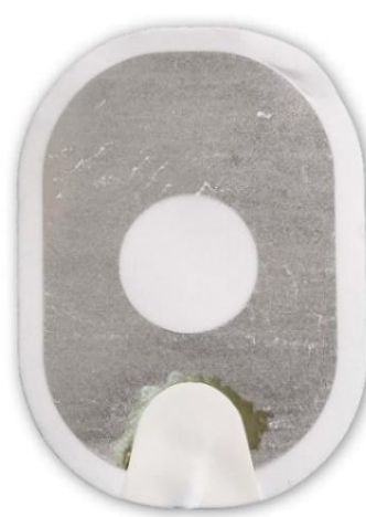
Figure 3 : gel presque complètement décollé du support.
