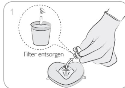
Maske festhalten und Filter nach außen und zur Seite ziehen, um ihn von der Maske zu lösen.
