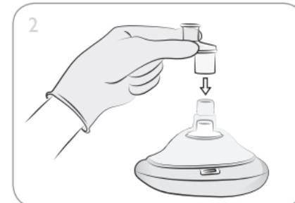
Das Einwegventil am Maskenanschluss befestigen.
