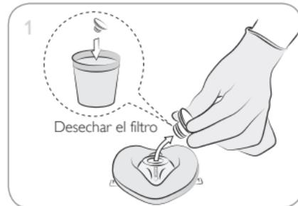
Sujete la mascarilla y saque el filtro tirando hacia fuera y hacia los lados, de modo que se separe de la mascarilla.
