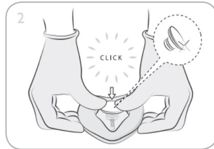
Maske auf einen harten, flachen Untergrund legen und einen neuen Filter einsetzen. Ausreichend Druck ist erforderlich, um sicherzustellen, dass der Filter ordnungsgemäß befestigt ist.
