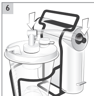
6 Verificare che tutte le connessioni dei tubi di aspirazione siano fissate saldamente.
