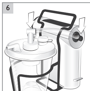
6 Sprawdzić solidność mocowania wszystkich złączy rurki podciśnieniowej.
