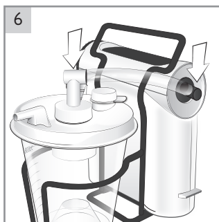
6 Sprawdzić solidność mocowania wszystkich złączy rurki podciśnieniowej.
