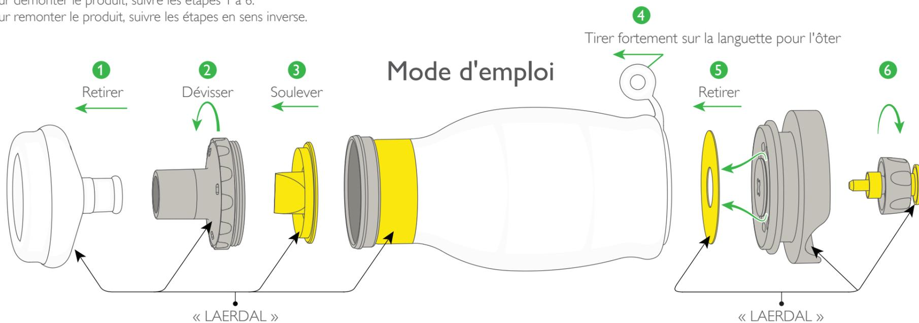
**!** Ne pas démonter les pièces au-delà des étapes indiquées. Pour le bon fonctionnement du dispositif, s'assurer que seules les pièces marquées LAERDAL sont utilisées (emplacements tels qu'indiqués ci-dessus).
