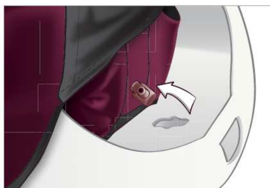
d) Tournez le connecteur à 90° pour le libérer de l'armature
