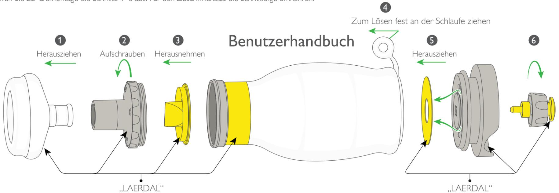
Teile nicht weiter zerlegen, als hier dargestellt wird. Verwenden Sie nur Teile, die mit der Aufschrift LAERDAL markiert sind (siehe Abb.), um eine einwandfreie Funktionstüchtigkeit zu gewährleisten.
