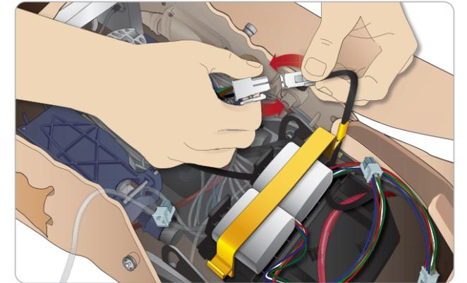
バッテリー接続後、患者シミュレータの電源をオフにした状態で患者シミュレータを外部電源 (12V から 24V) に接続します。
