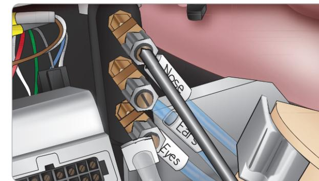
注：バルブを完全に外さないようにしてください。少し回すだけで調整できますので、ご注意ください。
