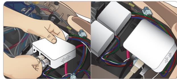
骨盤部を開きルーターを探します。2本の LAN ケーブルと黒い電源ケーブルを外します。
