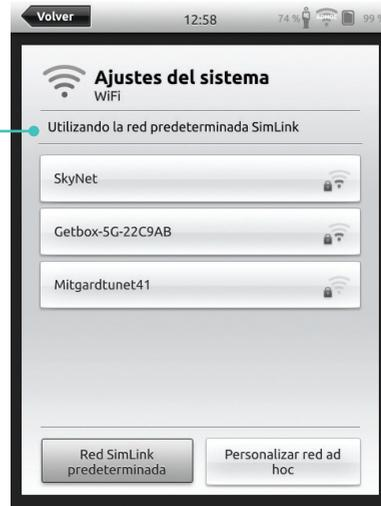
Si no hay otro Link Box visible en la red SimLink predeterminada, SimPad se conectará automáticamente con la que haya disponible. Este acoplamiento se recuerda y las unidades volverán a conectarse cuando vuelvan a encenderse. Cuando hay múltiples Link Box/ simuladores disponibles, elija la opción que prefiera.
