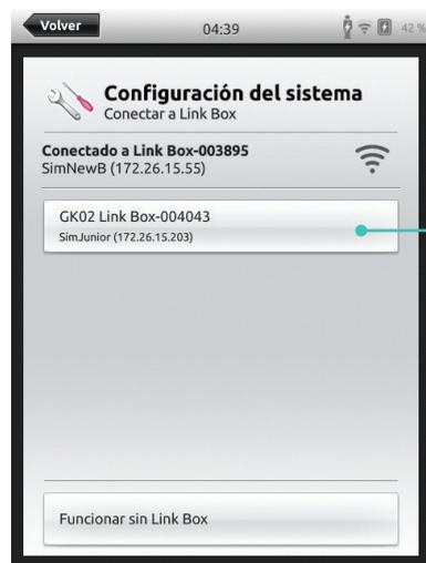
Seleccionar el Link Box/ simulador adecuado en el menú de conexión del maniquí
