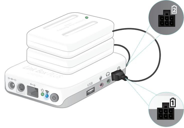
Las baterías se descargan de forma paralela
