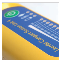
Panel de control, incluye: Botón On / Off, indicador de corriente externa, indicador de batería baja, y indicadores luminosos
