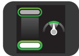
Stellt das CPRmeter fest, dass die Kompressionsfrequenz innerhalb des vorgesehenen Bereichs liegt, zeigt die „Tachonadel“ des Kompressionsfrequenzindikators auf den grünen Zielbereich, der zudem kurz aufleuchtet.
