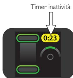
Dopo 1 minuto, il display del CPRmeter riduce l'intensità per conservare l'energia della batteria. Il display viene ripristinato, quando viene erogata una nuova compressione.
