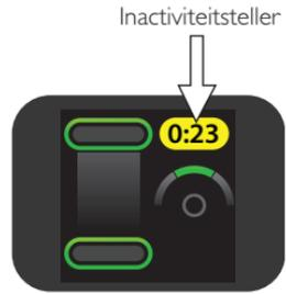
Na één minuut gaat de display van de CPRmeter uit om de batterij te sparen. De display wordt weer ingeschakeld zodra er een nieuwe compressie wordt uitgevoerd.
