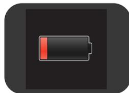
**WICHTIGER HINWEIS:** Sinkt die verbleibende Ladung der Batterie während der Durchführung einer CPR soweit ab, dass der Betrieb des CPRmeter nicht fortgesetzt werden kann, wird für zehn Sekunden das Symbol „Batterie schwach“ angezeigt; anschließend schaltet sich das CPRmeter aus.
