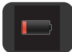
**REMARQUE IMPORTANTE :** si le niveau de puissance restant de la pile devient trop faible pour poursuivre un événement RCP, une icône de batterie faible s'affiche pendant 10 secondes et le CPRmeter s'éteint automatiquement.
