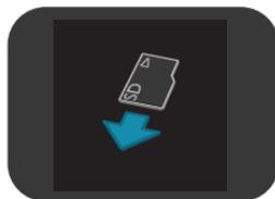
Wenn das Symbol "Speicherkarte wechseln" auf dem CPRmeter Display erscheint ist die Datenkarte voll und sollte ersetzt werden, damit ein möglicher Datenverlust bei nachfolgender CPR vermieden werden kann.
