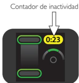
Tras 1 minuto, la pantalla del CPRmeter reduce la intensidad, para conservar la energía de la batería. Cuando se efectúa una nueva compresión, la pantalla se restablece.
