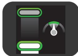
Indien de CPRmeter een compressie detecteert die meer bedraagt dan 70 mm, toont de CPRmeter de diepte-indicator onder het doelgebied. Indien een specifieke CPR-gebeurtenis vereist dat de CPR wordt uitgevoerd op een patiënt die op een matras ligt, dient u een plank onder de patiënt te schuiven en te compenseren voor de zachtheid van de matras door ervoor te zorgen dat voor iedere borstcompressie het gebied onder de compressiedieptewaarde oplicht.
