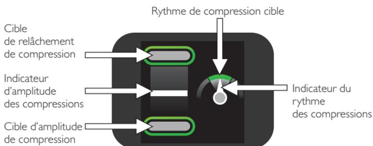
L'écran du CPRmeter fournit un feedback en temps réel au secouriste, tel que décrit ci-dessous.
