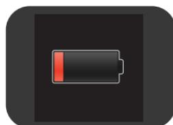
**!** *BELANGRIJK: Als de spanning tijdens gebruik te laag wordt voor verder gebruik van de CPRmeter, wordt het pictogram dat een te lage batterijspanning aangeeft gedurende tien seconden weergegeven en wordt het apparaat vervolgens automatisch uitgeschakeld.*
