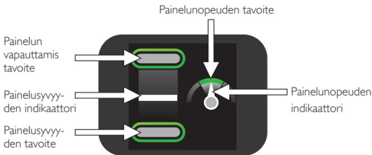
CPRmeter-elvytysmittarin näyttö antaa reaaliaikaista palautetta elvyttäjälle seuraavassa olevan kuvauksen mukaisesti.
