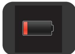
**NOTA IMPORTANTE:** Si la energía restante de la batería durante el uso llega a ser insuficiente para seguir funcionando, aparece el icono de batería baja durante 10 segundos y, a continuación, el CPRmeter se apaga solo.
