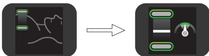
3. Suivez le feedback fourni par les indicateurs de l'écran du CPRmeter. Les indicateurs sont décrits dans la section suivante. Si aucun feedback du CPRmeter n'est constaté, retirez le CPRmeter et commencez les compressions thoraciques.
