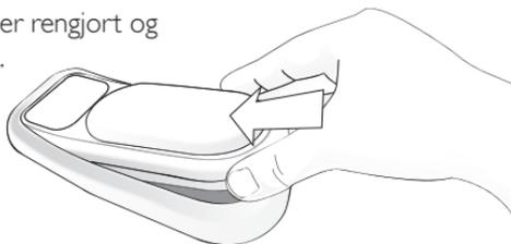
**VIKTIG!** Kom i gang med HLR så raskt som mulig. Hvis silikondekselet brukes regelmessig sammen med CPRmeter, bør dekselet og den store pasient-tapen settes på CPRmeter på forhånd.
