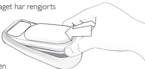
**VIKTIG ANMÄRKNING:** Silikonöverdraget skall endas användas tillsammans med de stora patient klistерplattorna. Använd inte de stora klistерplattorna utan att också använda silikonöverdraget.
