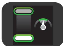
Si el CPRmeter detecta que la frecuencia de compresiones es correcta, la aguja del "velocímetro" en el indicador de frecuencia de compresiones apunta a la marca verde y ésta se ilumina durante un breve espacio de tiempo.
