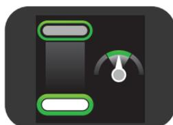
Si le CPRmeter détecte que le rythme des compressions est compris dans la plage des cibles, l'aiguille de l'indicateur de vitesse pointe dans la zone cible verte et la cible verte s'allume brièvement.
