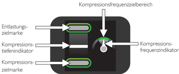
Das Display des CPRmeter liefert dem Ersthelfer ein Echtzeit-Feedback zu seinen CPR-Kompressionen. Dieses Feedback wird in den folgenden Abschnitten detailliert erläutert.
