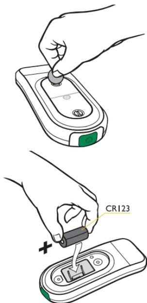
La spia di stato del CPRmeter lampeggerà verde ogni 5 secondi ad indicare che ha superato il test automatico e che la batteria può essere utilizzata.
