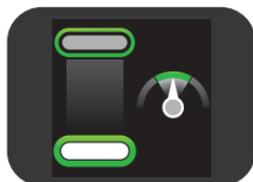
Hvis CPRmeter registrerer at kompresjonsfrekvensen er innenfor målområdet, vil «speedometer»-nålen på indikatoren for kompresjonsfrekvens peke mot det grønne målområdet, og det grønne målet lyser et kort øyeblikk.
