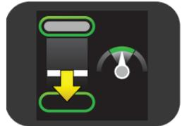
Stellt das CPRmeter fest, dass eine Kompression die erforderliche Kompressionstiefe überschreitet, wird der Kompressionstiefenindikator im Display unterhalb der Kompressionszielmarke angezeigt.
