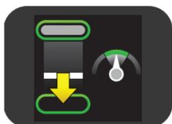
Indien 4 opeenvolgende compressies niet voldoen aan de minimale compressiedieptewaarde, verschijnt er een gele pijl op de display wijzend naar de streefwaarde voor de compressiediepte.
