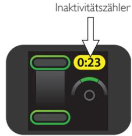
Nach einer Minute erlischt das Display des CPRmeter langsam, um Strom zu sparen. Werden erneut Kompressionen ausgeübt, wird das Display automatisch wieder aufgeblendet.
