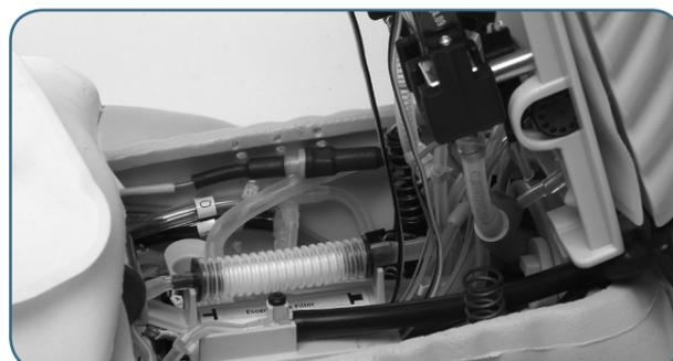
Podnieść płytę klatki piersiowej, odsłaniając części wewnętrzne i zlokalizować uchwyt filtra.
