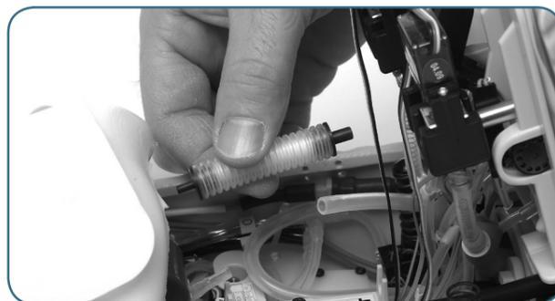
Lösen Sie den Filter und ersetzen Sie ihn durch einen neuen. Bringen Sie Brustplatte und Brusthaut wieder an (siehe Abschnitt *Auswechseln der Blase*).
