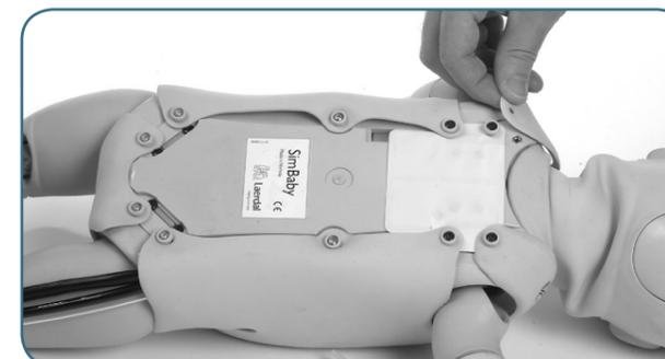
Entfernen Sie die Haut an den Torsoseiten und lösen Sie die Lasche auf der Innenseite des Bauchnabelbereichs aus ihrer Halterung.
