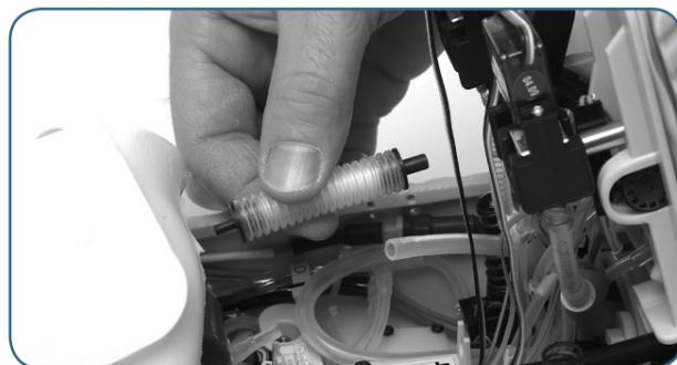
Ontkoppel de filterassemblage en vervang het met een nieuwe. Plaats de borstplaat en de borsthuid (zie het hoofdstuk *Vervangen van de ballon*).
