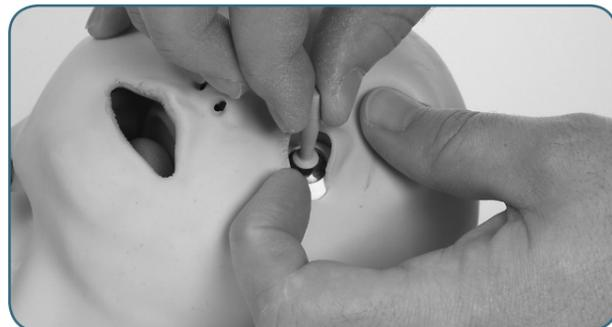
Pour ajouter une des pupilles jointes au simulateur, ouvrez les paupières avec vos doigts, retirez de son assise la pupille en place en utilisant le dispositif de remplacement oculaire fourni, puis installez la pupille souhaitée dans son assise en utilisant ce même outil.
