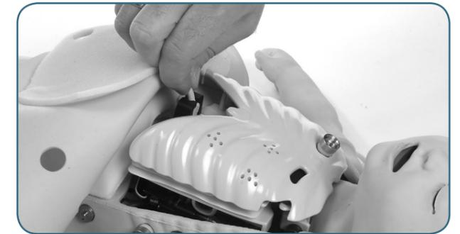
Heben Sie die Brustplatte ab, sodass Sie Zugang zu dem darunter liegenden Bereich erhalten.
