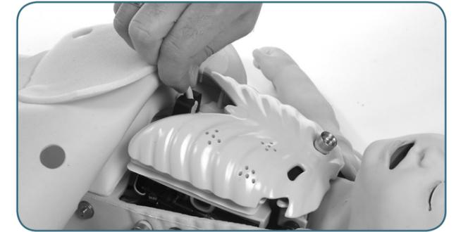
Til de borstplaat assemblage op, waardoor de onderzijde wordt blootgesteld.
