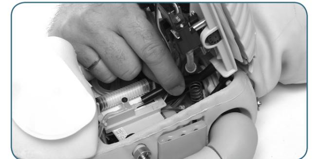
Lösen Sie den Blasenschlauch vom Nippel.
