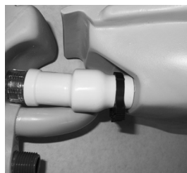
Fot. 13 (Zacisk założony. Zaciśnięć, by uszczelnić).
