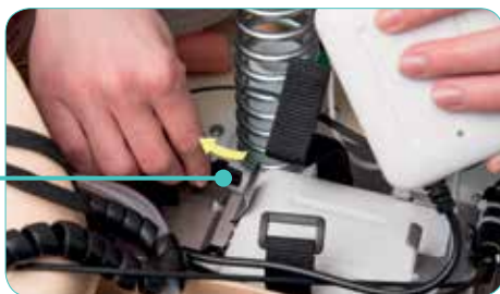
Fjern batterikobling fra Link Box.
