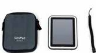
SimPad (Link Box mit Lithium-Ionen-Akku im Trainingsmodell eingesetzt), SimPad-Handgelenksschleife und -Schutzhülle
