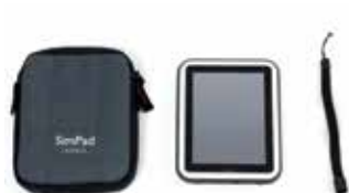
SimPad (Link Box con batteria agli ioni di litio installata nel manichino). Custodia e fascia da polso del SimPad
